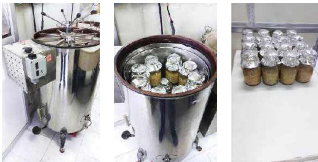
يمين: تغطية المطريانات بفلتر خاص للتنفس، وسط ويسار: وضع وتعقيم المطريانات بالأتوكلاف
